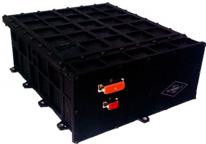
液桥热毛细对流实验箱（中国科学院力学研究所国家微重力重点实验室研制）
