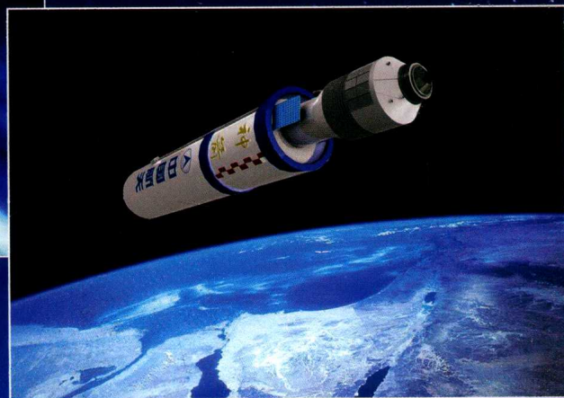
⑦飞行到582秒，火箭二级发动机在燃料用尽后停止工作
