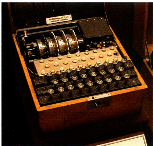
世界上第一部密码机——Enigma机
